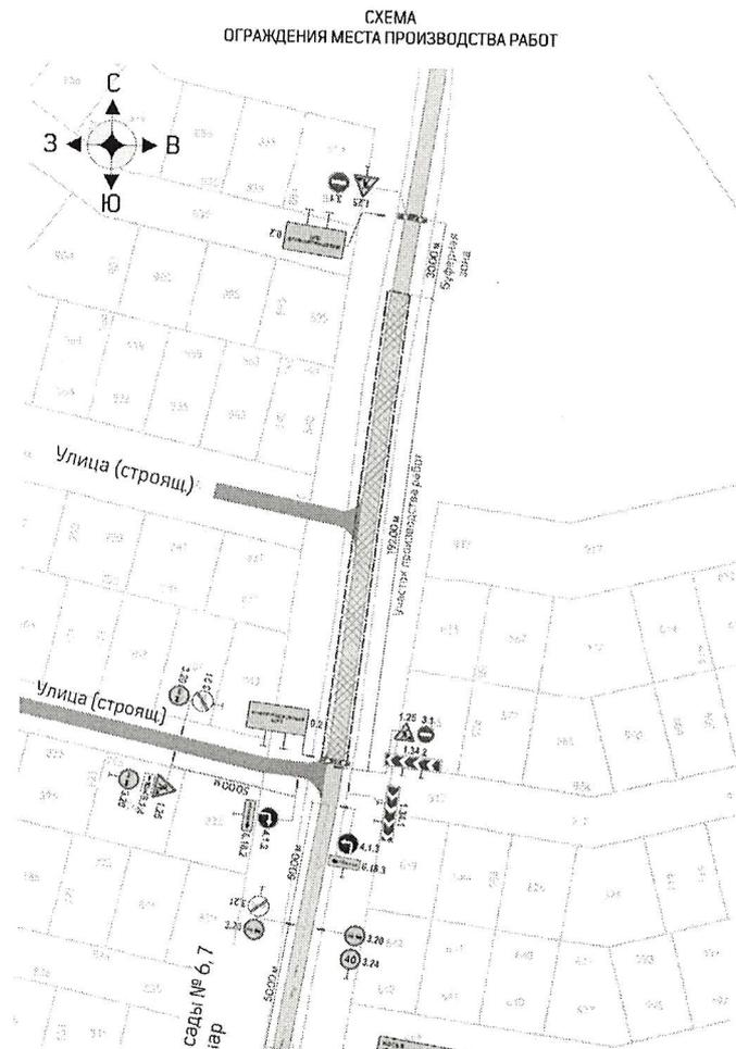
Схема размещения технических средств организации дорожного движения на период производства работ
