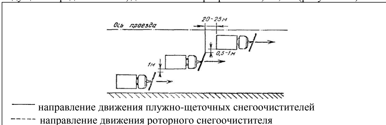
Рис. 6.5. Схема расчистки проезжей части улиц колонной плужно-щеточных снегоочистителей и складирование снега в лотке
