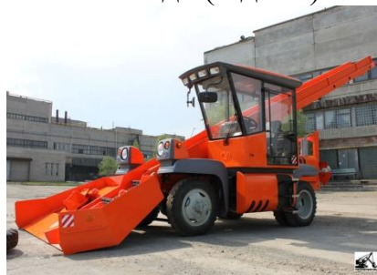
Рис. 6.20. Лаповый снегопогрузчик КО-206.
