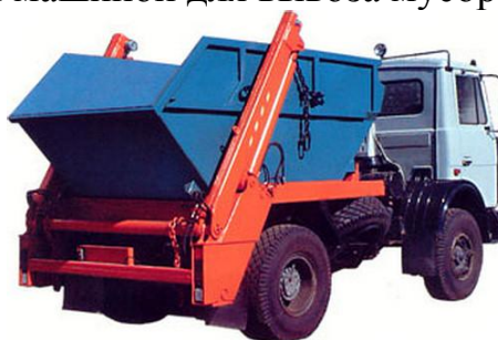
Рис. 4.14. Бункеровоз МКС-3501 на шасси МАЗ-5551А2
