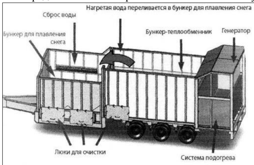
Рис. 6.4. Схема работы снегоплавильной установки
