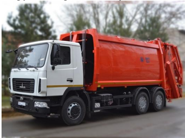
Рис. 4.13. Мусоровоз с задней загрузкой КО-427-90 на базе шасси МАЗ-6312С3
