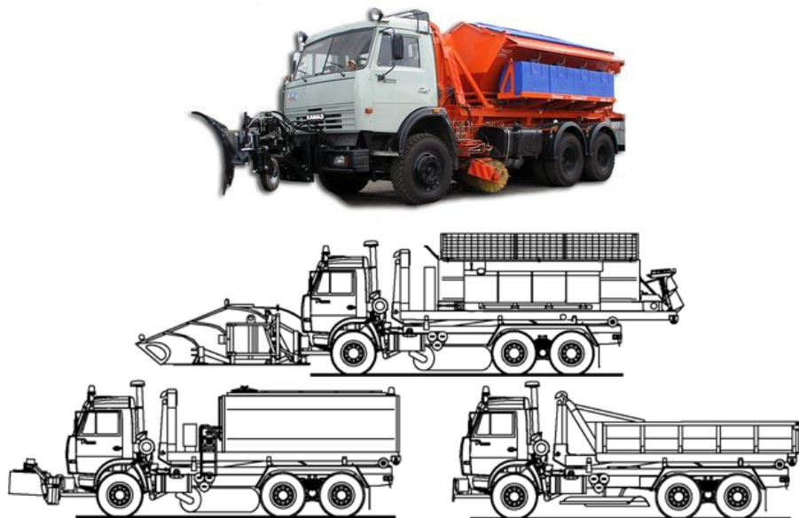
Рис. 6.19. Комбинированная машина МКДС-4107.
